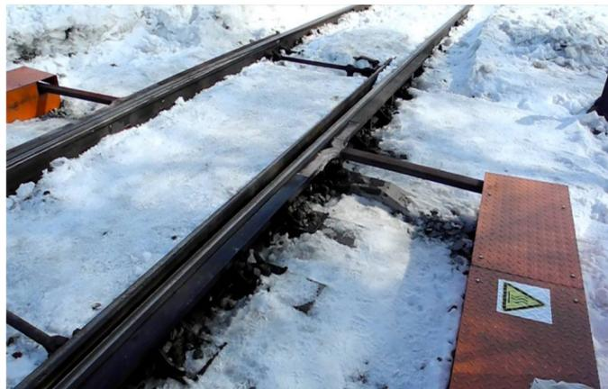
Система газового обогрева
